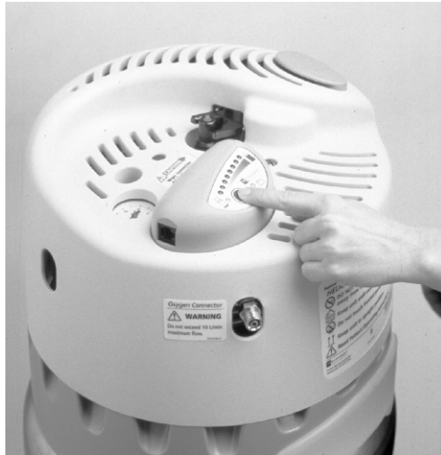
Σχήμα 11: Έλεγχο περιεχομένου οξυγόνου της δεξαμενής
